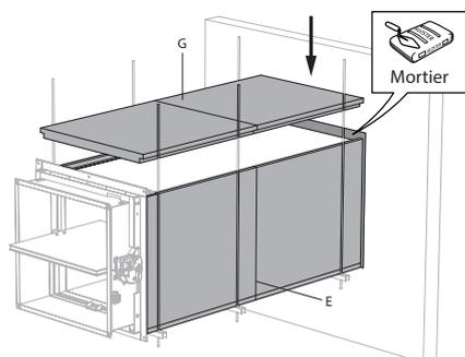
5. La réservation autour de la gaine dans la paroi est remplie par du mortier ordinaire. La gaine traversante est recouvert de plaques de staff de référence GEOFLAM F d'épaisseur 45 mm ou GEOFLAM Light d'épaisseur 35 mm « G ». Les plaques sont fixées entre elles autour de la gaine par colle et polochonnage « E ». Le corps du clapet est également ainsi protégé sur une longueur de 120 mm.
