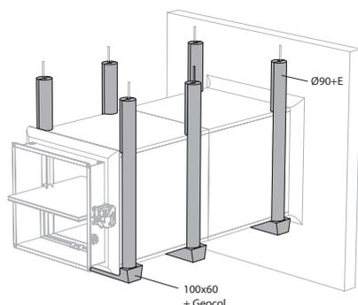
7. Les tiges filetées sont protégées par ½ coquilles en staff Ø 90 mm et maintenues entre elles par colle et polochonnage. La traverse est protégée par un profilé en « U » de protection en GEOFLAM 100 x 60 mm, collé à la sous-face du conduit par du plâtre pour collage de type GEOCOL (GEOSTAFF).
