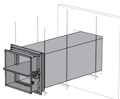
3. L'ouverture de dimensions maximales « A » est réalisée au travers de la paroi.
