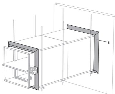
6. La protection en staff GEOFLAM F s'arrête à 15 mm du mur. L'espace libre entre le mur et la protection en staff est comblé par bourrage de polochons (mélange de plâtre et de filasse). Ce bourrage est également appliqué sur la jonction entre le conduit et le tunnel du clapet.
